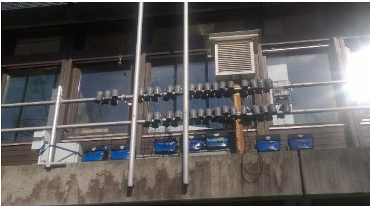
Abb. 1: Vergleichsmessungen der 30 SDS011 Sensoren und Fahrradtaschen am Institut für Geographie.
